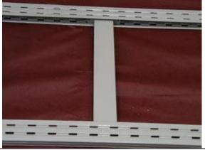
Таким же образом прикрепите поперечину ко второй стойке.
