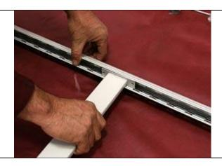
Сборка стеллажа начинается со сборки боковых рам. Заведите поперечину одним концом в первый паз стойки примерно посередине ее длины...
