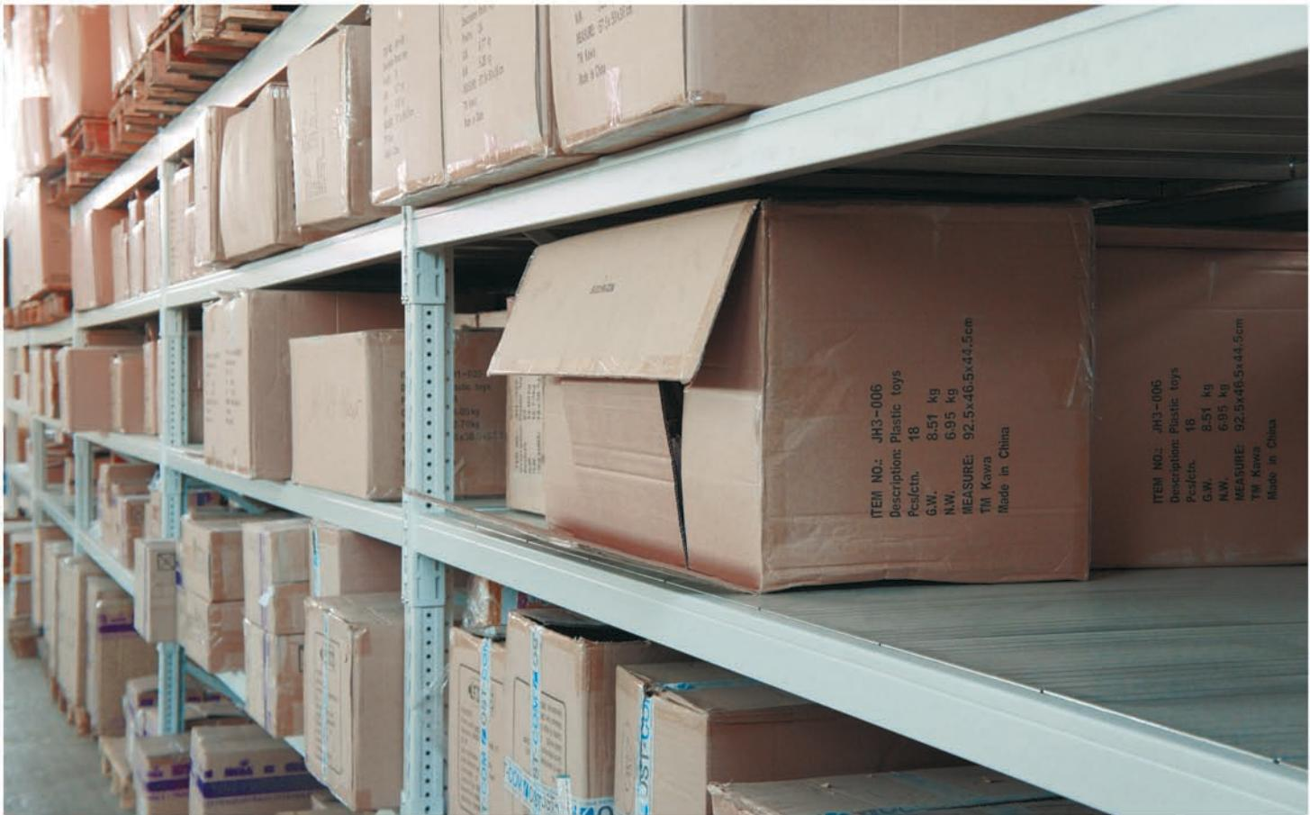
**Большегрузные полочные стеллажи** – это стеллажи с ручной обработкой груза на базе паллетных стеллажей. Идеально подходят для хранения товара, уложенного в коробки различных габаритов или имеющего индивидуальную упаковку. Данная система хранения оптимальна как для зон комплектации заказов на складах, так и для зон хранения мелкого товара. Словом, они отлично подойдут там, где необходима надежность, долговечность и удобство в обработке груза без использования складской техники.
