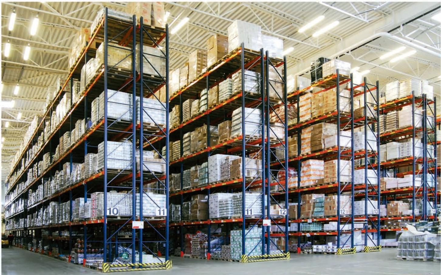
**Стеллажи паллетные (фронтальные)** представляют собой конструкцию, собранную из отдельных элементов - металлических балок и рам. Балки крепятся к рамам при помощи зацепов и могут регулироваться по высоте с шагом 50мм. Находят применение на крупных складах и используются для хранения паллетированного груза (груза на поддонах). Стеллажи могут быть любой длины и использоваться в любых помещениях.
